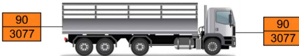
Figura 65: Veicoli trasportanti materie pericolose in cisterne
