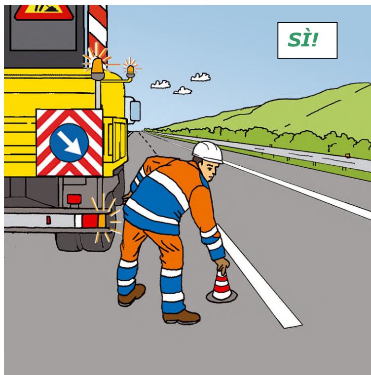
Figura 59 – Posizionamento dei coni o defleco: comportamento corretto
